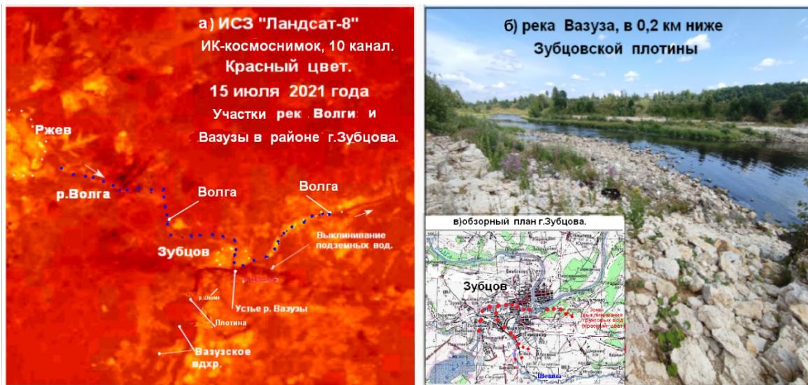
Рис. 15. Выклинивание грунтовых вод ниже плотины Зубцовского гидроузла.
