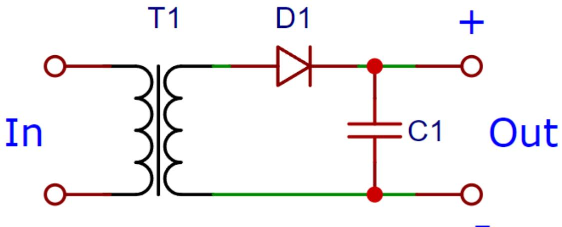
Рис. 1. Однополупериодная схема выпрямителя
