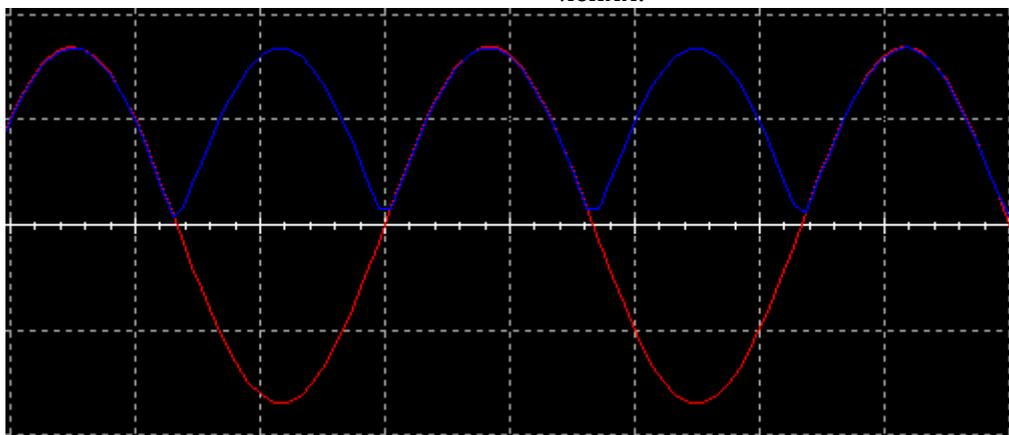
Рис. 8. Осциллограмма мостового выпрямителя напряжения без фильтра
