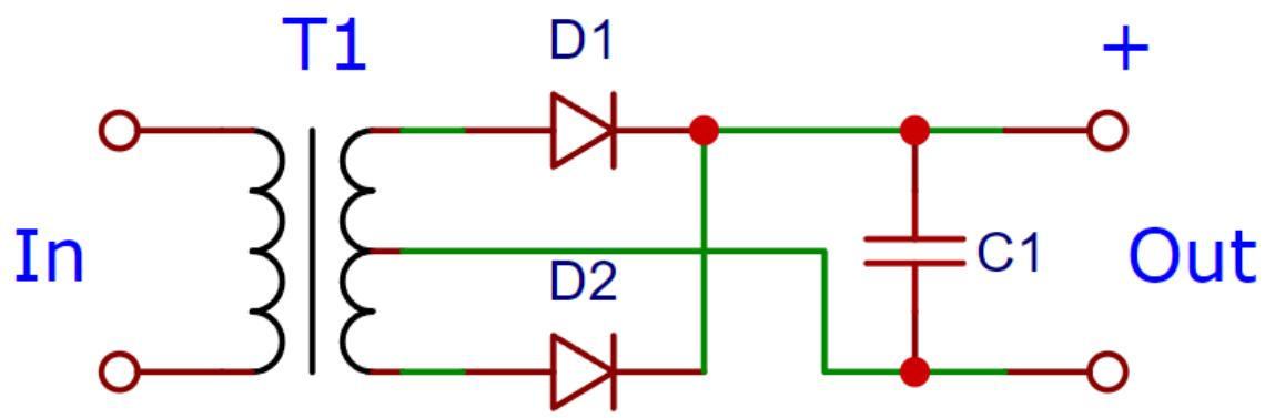
Рис. 4. Двухполупериодная схема выпрямителя
