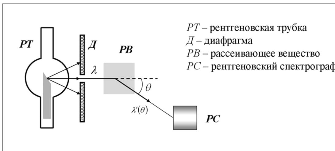
Рис. 2. Схема эксперимента
